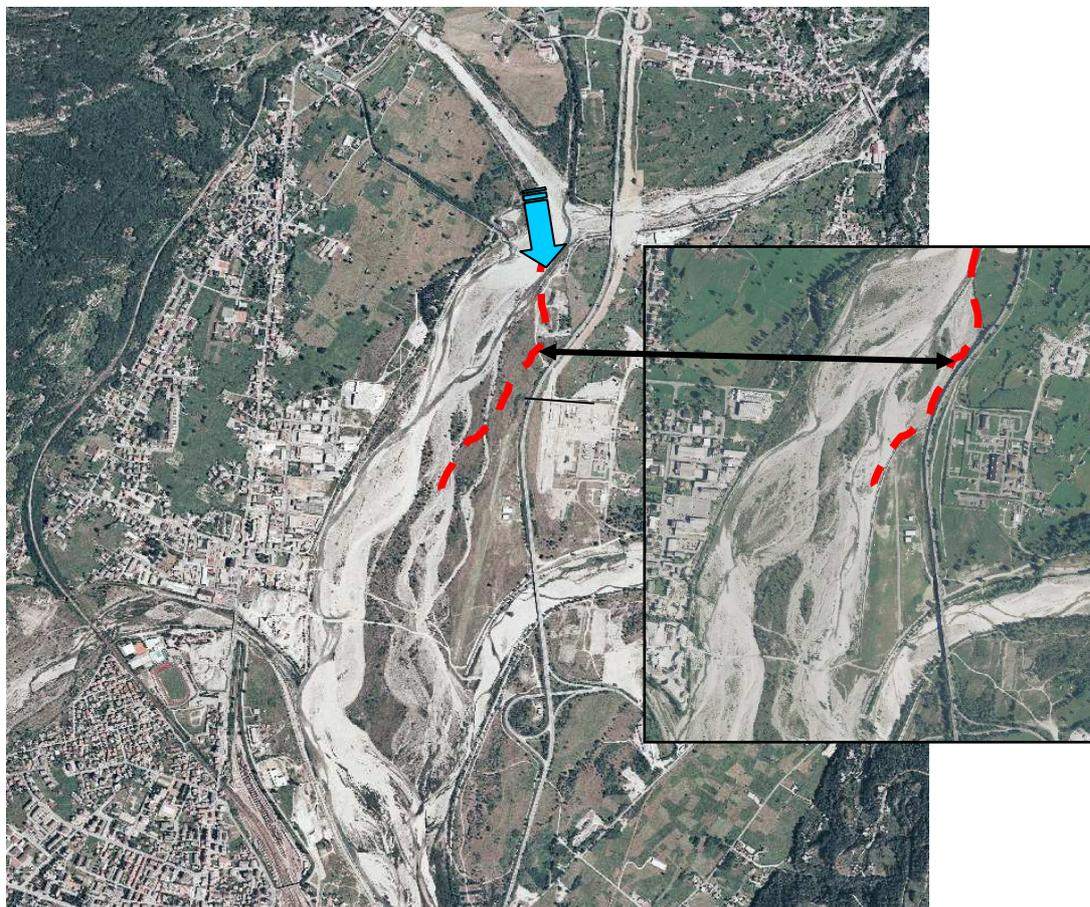
Figura 10. Raffronto tra la morfologia dell'alveo attivo a valle dell'immissione Diveria-Isorno prima (ortoimmagine 1999, sinistra) e dopo l'evento 2000 (ortoimmagine 2006, destra). Si osservi la linea di erosione del terrazzo alluvionale prospiciente al rilevato della S.S. del Sempione, che porta quest'ultimo ad essere esposto direttamente alle pulsazioni della corrente di piena provenienti dal Diveria (freccia azzurra)
