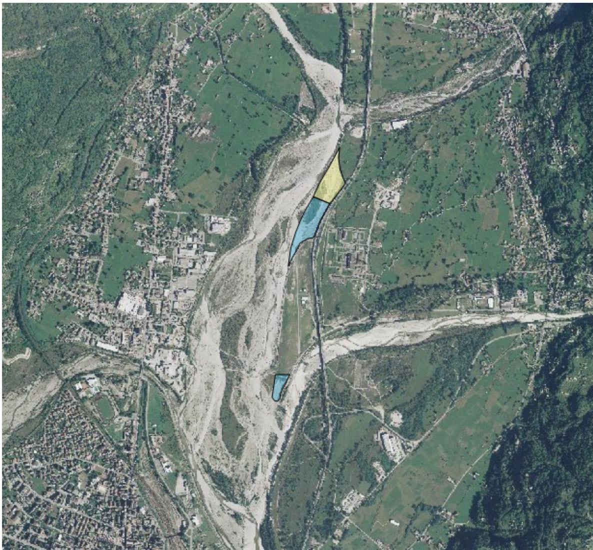
Figura 7. Figura 8. Panoramica del nodo idraulico tratta da ortofoto digitale del 2006. Con campitura di colore azzurro sono evidenziate le aree di espansione del rilevato delle piste (coincidente con area di accumulo di materiale di disalveo da progetto AIPO 2005). In giallo è riportata l'ulteriore area di accumulo di materiale di disalveo prevista da AIPO
