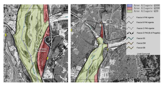
Figura 12. Simulazione superfici allagabili (Studio di fattibilità della sistemazione idraulica del F. Toce, AdBPo 2003)
