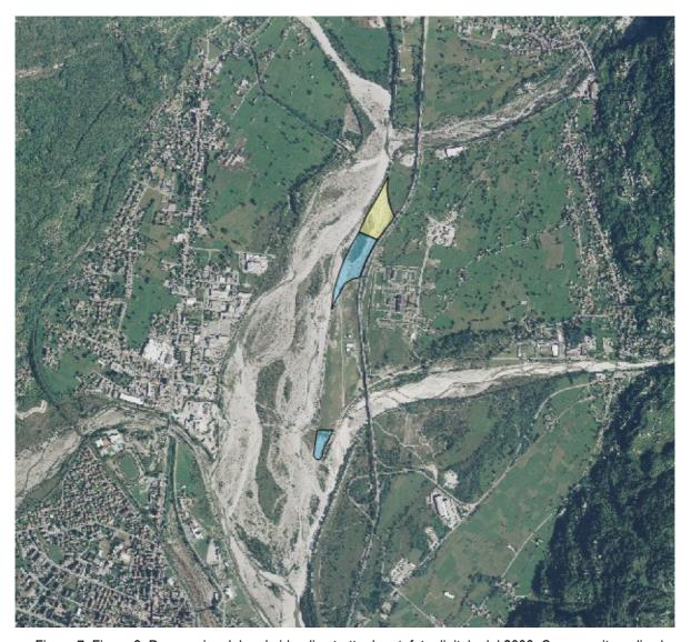
Figura 7. Figura 8. Panoramica del nodo idraulico tratta da ortofoto digitale del 2006. Con campitura di colore azzurro sono evidenziate le aree di espansione del rilevato delle piste (coincidente con area di accumulo di materiale di disalveo da progetto AIPO 2005). In giallo è riportata l'ulteriore area di accumulo di materiale di disalveo prevista da AIPO
